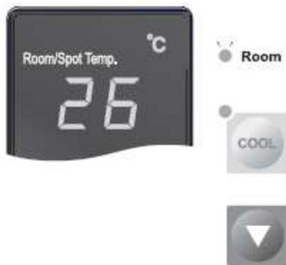
1. Zur Anzeige der Raumtemperatur betätigen Sie die Cool-Taste und die ▼-Taste 3 Sekunden lang gleichzeitig.
