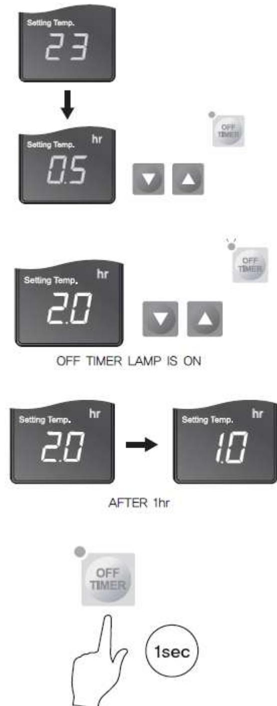
1. Betätigen Sie im Kühlbetrieb die Off Timer-Taste und stellen Sie die gewünschte Zeitspanne durch Betätigen der ▲-Taste oder der ▼-Taste ein. Durch jede Betätigung der jeweiligen Taste wird die Zeitspanne bis zum Ausschalten des Gerätes um je 30 Minuten erhöht (bis 10 Stunden) und danach (nach 10 Stunden) um je 1 Stunde (bis 24 Stunden). Im Display wird 0.5 für 30 Minuten und 1 für 1 Stunde angezeigt. (Z.B. Displayanzeige „1,5“ = eineinhalb Stunden)
