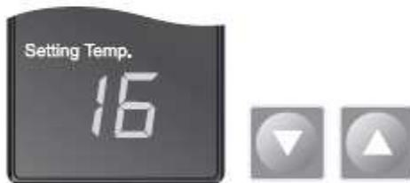
2. Durch Betätigen der ▲-Taste oder der ▼-Taste wird die Temperatureinstellung verändert.
