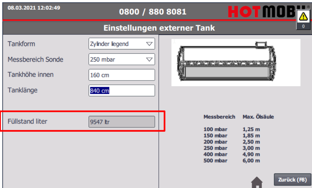
Abbildung 17 Füllstand externer Tank
